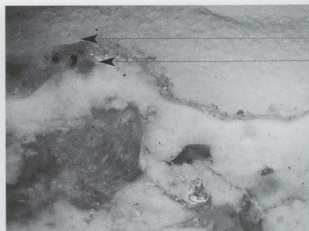
Obr. 20. Švihov (okres Klatovy), státní hrad, dvorní průčelí jižního paláce. Příčný řez povrchem pozdně gotické omítky, která tvoří podklad pod renesančním sgrafitem. Viditelné světlo, cca padesátinásobné zvětšení. Na povrchu omítky, která byla delší dobu bez sgrafita, je pod vrstvičkou depozitů (vrstva 2) rozlišitelný cca 0,2 mm silný vápenný nátěr, provedený velmi pravděpodobně technikou al fresco (vrstva 1). (Foto Dagmar Michoínová, 2003)
